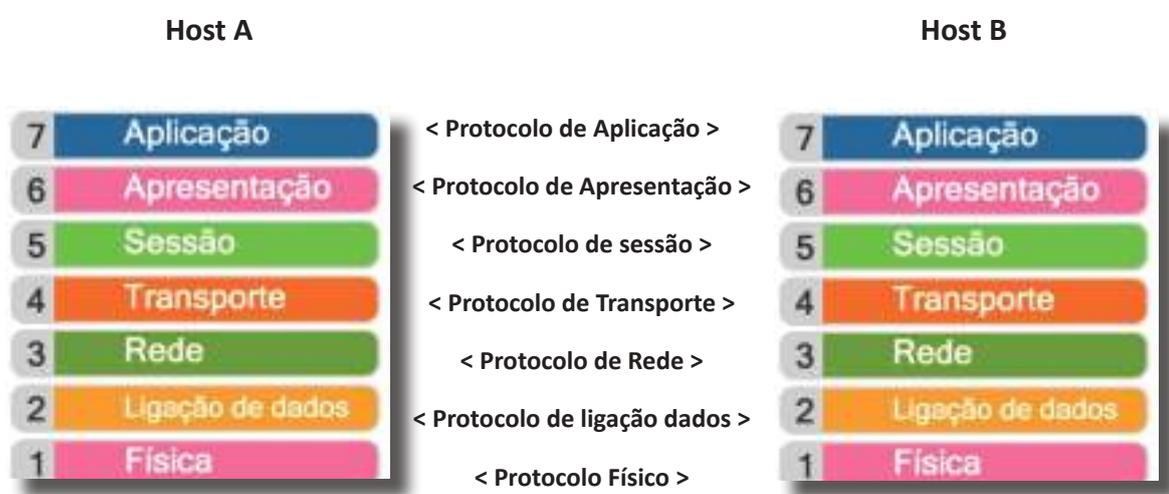
Fig. 2: Camadas do modelo OSI
