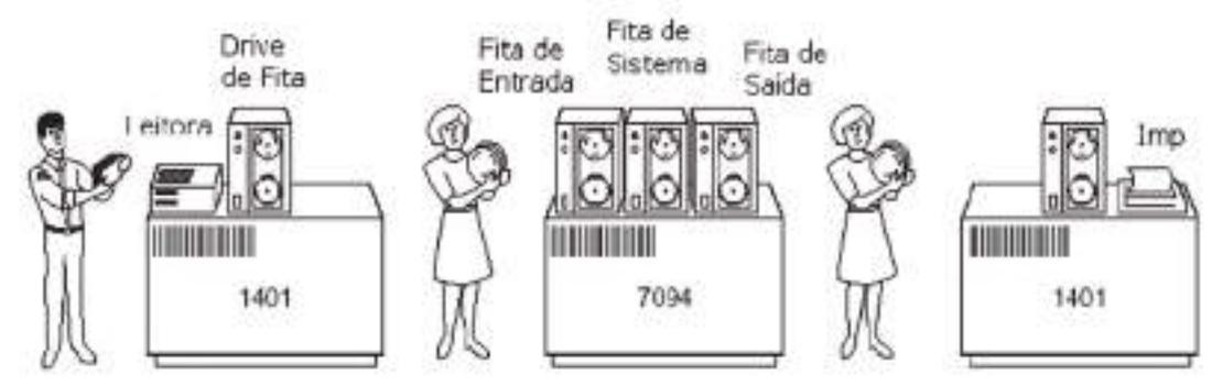
Fig. 4: Sistema de Processamento em Batch
